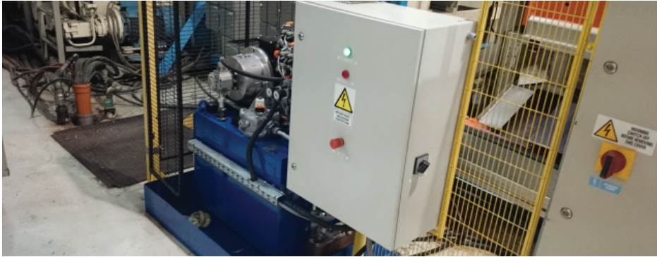
► Agregat Sytronix - napęd hydrauliczny wykrawarki dwukrawędziowej w firmie Whirlpool Polska
